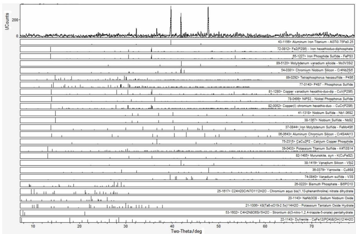
图 3 含钒磷铁矿样 X 射线粉末衍射分析图
