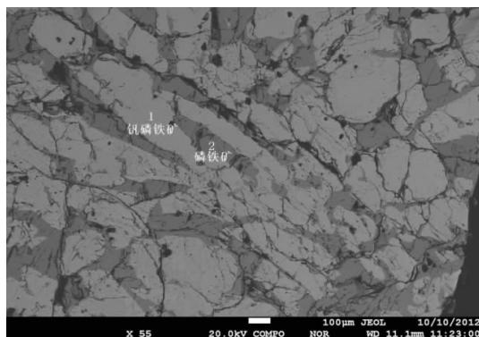
图2 含钒磷铁电子探针背散射图
