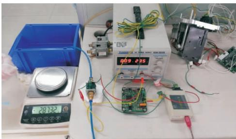
图9 电磁泵流量测试图
