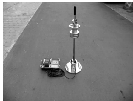
图1 手持式落锤弯沉仪(PFWD)
