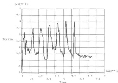
图 3 节点 2034 的等效弹性应变随时间变化规律 (0.8m)
