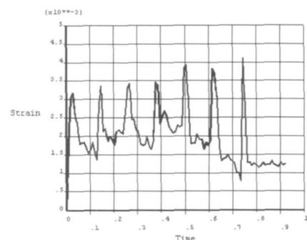
图 6 节点 2034 的等效弹性应变随时间变化规律 (0.8m)
