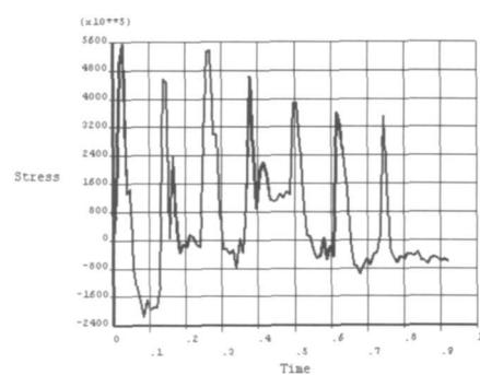
图 5 节点 2034 横向应力  $\sigma_x$  随时间变化规律 (0.8m)
