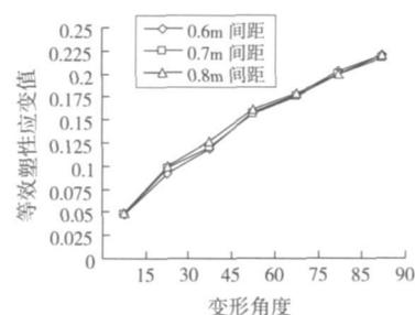
图 7 板料圆角处应变随轧辊间距的变化曲线图
