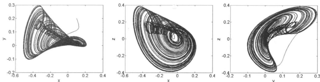
图 2 系统处于混沌时的典型吸引子
